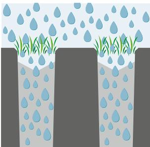
Die Technik ist so einfach wie überzeugend: Begrünte Fugen und Steinkammern speichern und lassen das Niederschlagswasser in tiefere Bodenschichten versickern.
