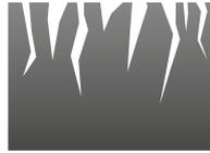
Wasser und Schmutz können in die Poren und Kapillaren der ungeschützten Betonoberfläche eindringen. Verschmutzungen lassen sich somit schwerer entfernen als bei tiefengeschützten Oberflächen.
