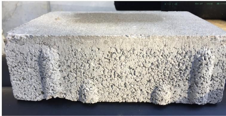
Abbildung 2: Detailaufnahme vom zweilagigen Hybrid-Pflasterstein System –hp-protect
