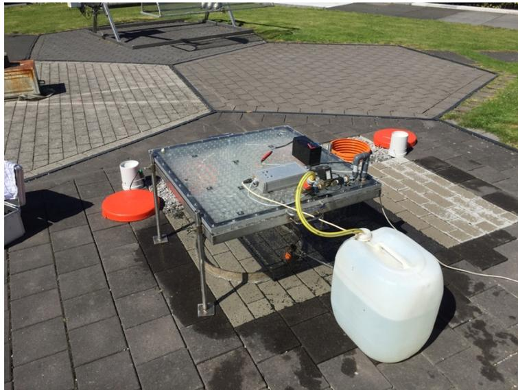
Abbildung 16: Messung der spezifischen Versickerungsrate mit Tropf-Infiltrometer
