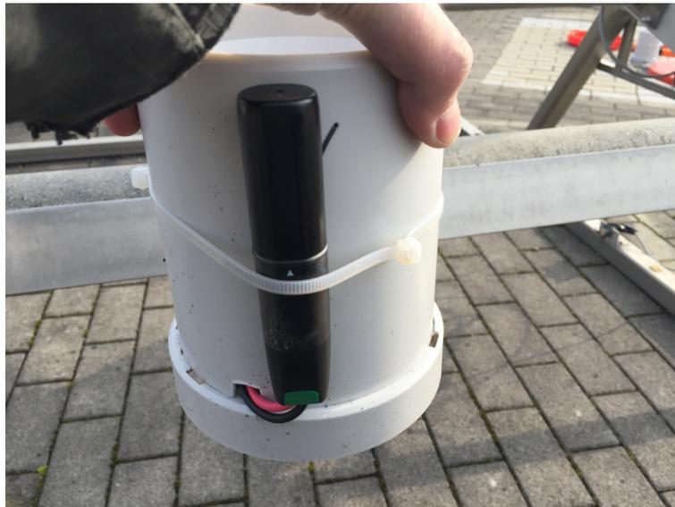
Abbildung 10: Kippzähler mit Datenlogger (Counter)
