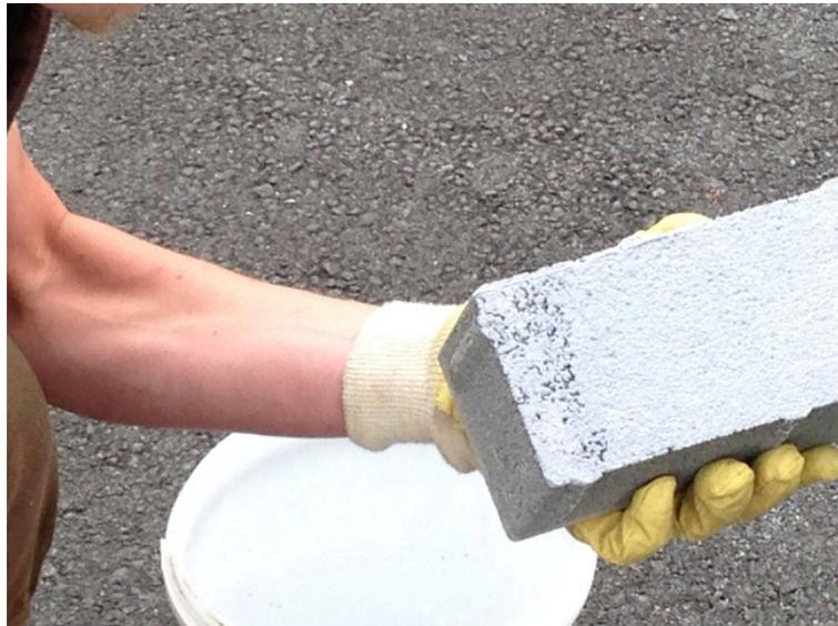
Abbildung 4: Dreilagiger Pflasterstein mit abgedichteter Sohle
