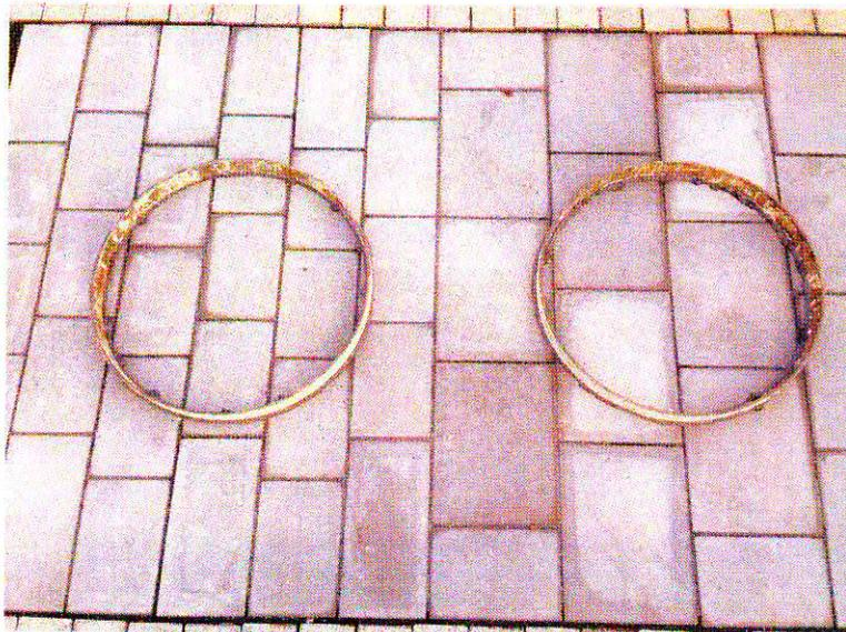
Abbildung 3: Das Testfeld mit aufgeklebten Test-Ringen
