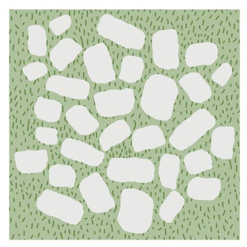
**Weite Verlegung** Eine Palettenlage ergibt 0,77 m² Bis zu 50% Flächenbegrünung.
