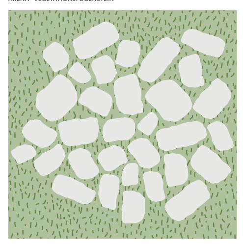
**Enge Verlegung** Eine Palettenlage ergibt 0,69 m² Bis zu 30% Flächenbegrünung.
