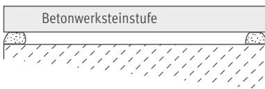
Bei Längen über 110 cm sind die Mörtelstreifen nach innen zu verlegen (auf 1/6 der Gesamtlänge, nicht breiter als 12 cm). Mittige Auflagerungen sind bei längeren Stufen in Position und Ausbildung vom Tragwerksplaner zu dimensionieren und zu platzieren. Dies geschieht in regelmäßigen Abständen und unterstützt die Stufe. Damit werden die statischen Auflasten der Nutzung kompensiert. Prinzipiell ist in jedem Fall zwängungsfrei zu verlegen.
