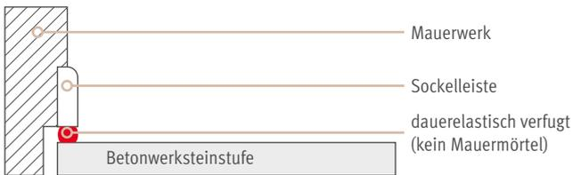
Verlegung nur auf zwei Mörtelstreifen am äußersten Ende der Betonwerkstufen.
