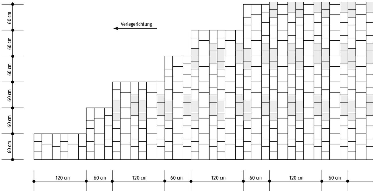
Ideal für GEOSTON CARMA ist die klassische Bahnenverlegung. Hier werden alle Steine verwendet, es bleibt kein Stein übrig. Für den Randabschluss müssen bei Einhaltung dieses Rasters keine Steine geschnitten werden.
