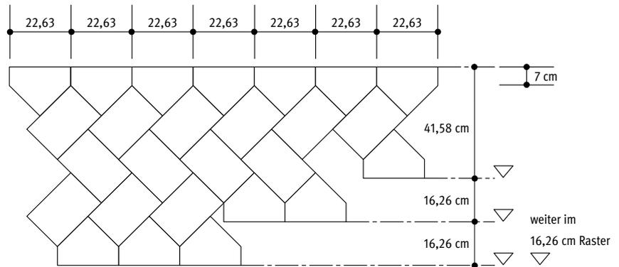
Wir empfehlen die Diagonalverlegung oder den Fischgrätverband. Im Gegensatz zum Läuferverband werden hier die Horizontallasten auf mehrere Steine verteilt.
